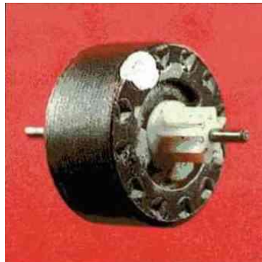
Rotor o inducido de un motor de alterna de inducción. Obsérvese que no precisa ningún tipo de contactos de excitación.
