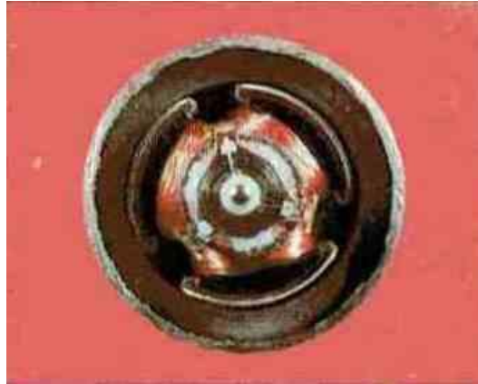
Interior de un motor de corriente continua. Se observa el imán permanente del inductor que rodea al inducido.
