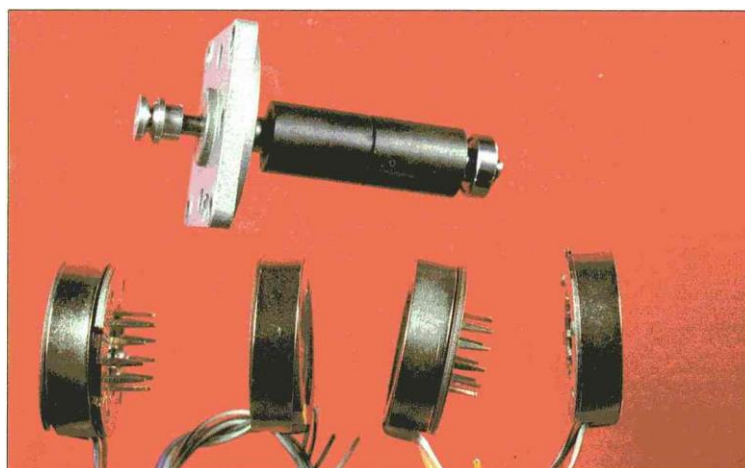
Otro modelo de motor constituido por varios conjuntos rotor-estátor alineados sobre el mismo eje.
