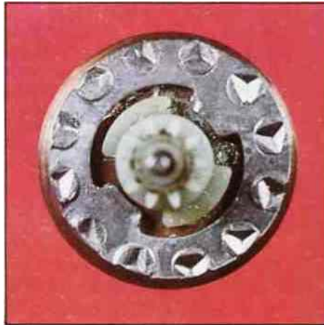
Rotor de un motor de inducción formado por discos contiguos, cortocircuitados en los bordes.
